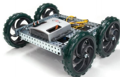
Рис. 10.4. Пример платформы на колесном ходу ( a ), собранный МР ( б ).
